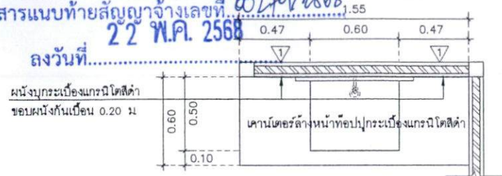
แบบขยายแปลนคาน้ำเตอร์ล่างหน้า 1:25
